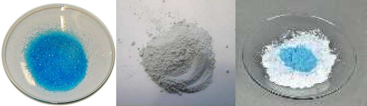
Si le sulfate de cuivre reste blanc, alors le liquide ne contient pas d'eau.
